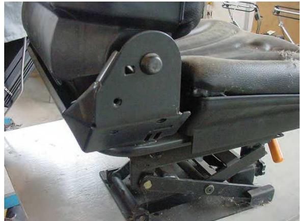
Le cinture di sicurezza, dove non previste all'origine dal costruttore della trattrice, devono essere installate, laddove tecnicamente possibile, permettendo il molleggio del sedile e garantendo la solidità dei punti di ancoraggio. Se non predisposto, è pertanto necessario sostituire il sedile con un altro provvisto di cinture o di altro idoneo sistema di ritenzione del conducente, che garantisca la solidità e gli spazi di manovra del sedile originale.
