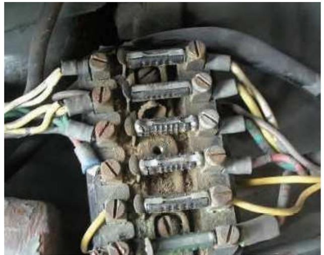
Cavi e le spine elettriche devono essere fissati alla trattrice per evitare pericoli di schiacciamento e di corto circuito, inoltre i cavi elettrici devono essere protetti da usura per sfregamento su superfici metalliche.
