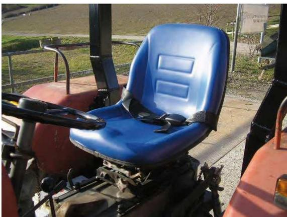
La sostituzione del sedile deve essere effettuata da Ditta competente secondo la **Linea Guida ISPESL che rilasci Certificato di Installazione.**
