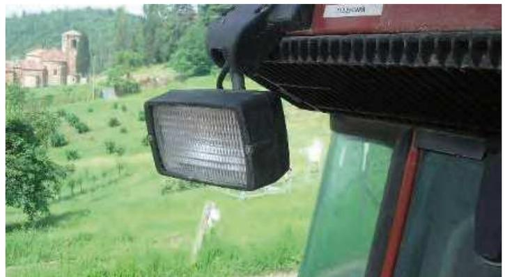
attrezzature portate, la trattrice deve essere dotata di un lampeggiante giallo o arancione, collocato in posizione ben visibile.
